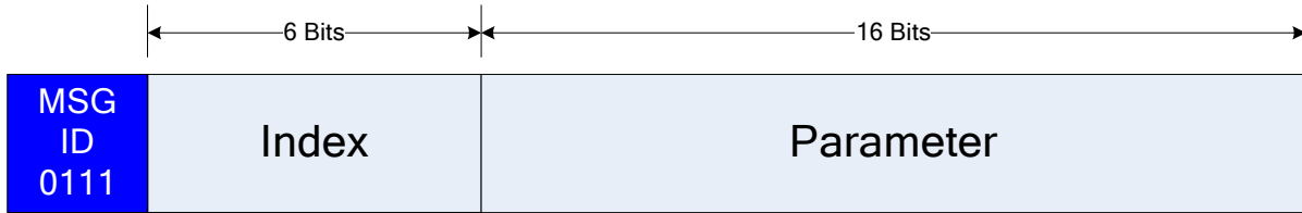
Figure 4-11: SIS Parameter Message – Message Structure
