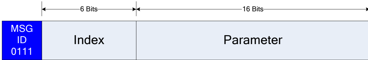
Figure 4-9: SIS Parameter Message – Message Structure
